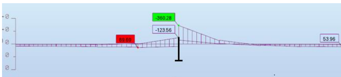
Figura 28 – Momento fletor negativo e positivo máximo kNm (Pilar indicado na figura)
