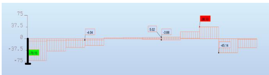
Figura 30 – Momento de torção máximo kNm (Pilar indicado na figura).
