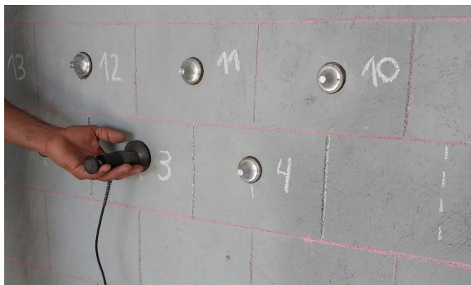
Figura 25 – Aderímetro utilizado para a realização do ensaio de resistência de aderência à tração
