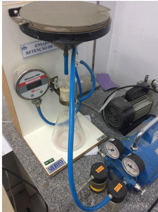
Figura 31 - Retenção de água (NBR 13277 (ABNT, 2005b))
