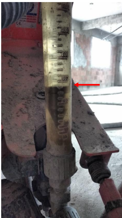
Figura 14 - Rotômetro com a vazão de 550 litros/hora
