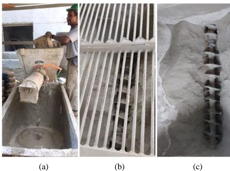
Figura 16 – Argamassadeira utilizada para a aplicação do revestimento aplicado manualmente em obra a) Aspecto visual do misturador mecânico; b) grelha serrilhada; c) eixo horizontal
