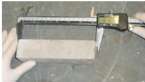
Figura 38 - Densidade de massa aparente no estado endurecido aos 28 dias (NBR 13280 (ABNT, 2005))
