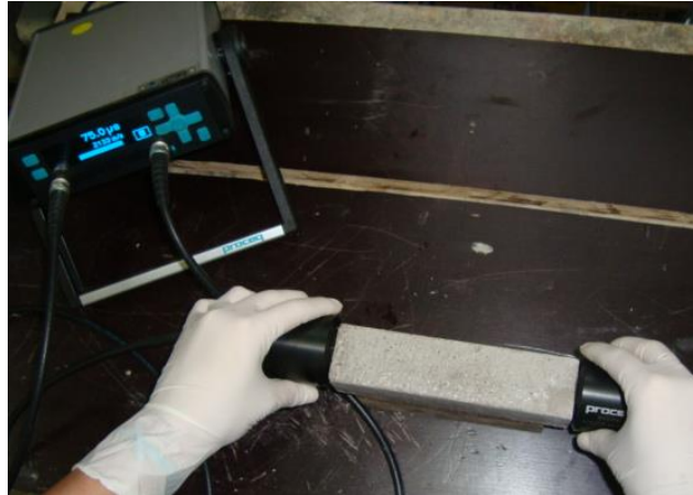
Figura 37 - Módulo de elasticidade dinâmico aos 28 dias (NBR 15630 (ABNT, 2008))
