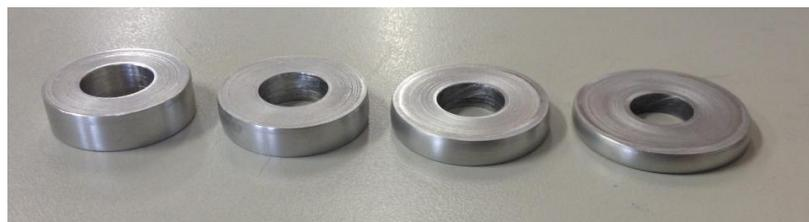
Figura 3.15 – Corpos de prova de Alumínio AA5052 para o ensaio do anel com diferentes reduções
