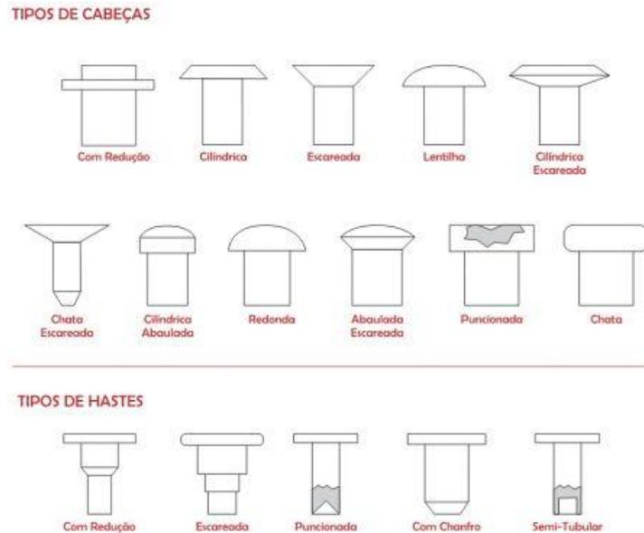
Figura 2.1 - Tipos de cabeças e hastes dos rebites [2]
