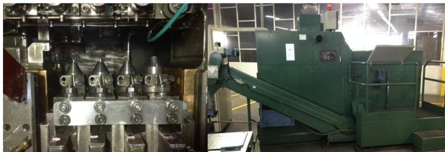
Figura 2.13 - Região onde ocorre a conformação (esq.) e prensa de 4 golpes (dir.)
