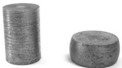
Figura 2.26 - Corpos de prova utilizados para a realização do ensaio de compressão; antes do ensaio (esquerda) e depois do ensaio (direita)
