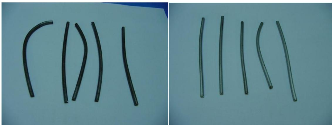
Figura 3.24 - Amostras ensaiadas de 410 (esq.) e 302 (dir.)
