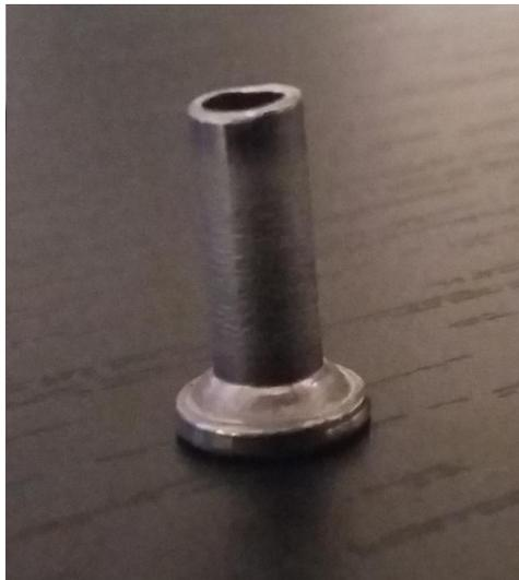
Figura 7.3 - Rebite conformado com depósito de material entre o corpo e a cabeça
