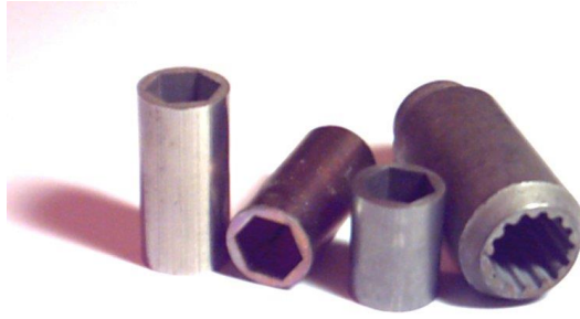
Figura 9 – Peças bomba d'água. Liga: aço inoxidável 316L.
