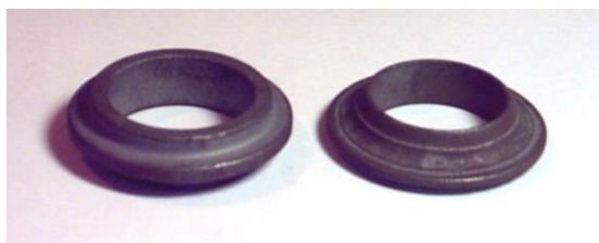
Figura 7 – Buchas para máquina agrícola. Liga Fe-Cu-C. Tratamento térmico de cementação. Dureza 48 - 52 RC. Camada cementada: 0,3 - 0,5 mm.
