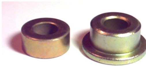
Figura 7 – Buchas para máquina agrícola. Liga Fe-Cu-C. Tratamento térmico de cementação. Dureza 48 - 52 RC. Camada cementada: 0,3 - 0,5 mm.
