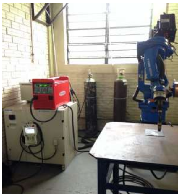
Figura 4. 15 - Sistema de soldagem.
