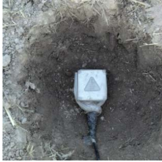
Figura 19 - Enterramento do geofone.
