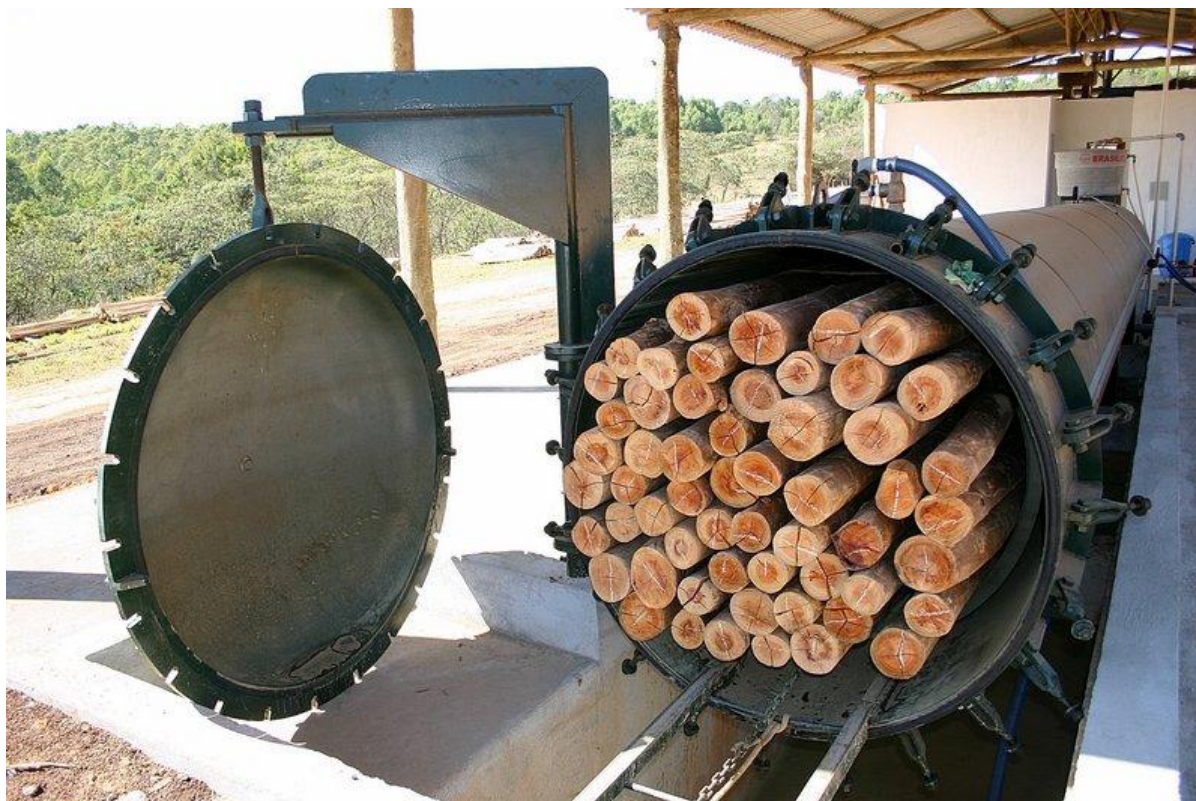
Figura 7 – Autoclave da empresa Verde Madeiras.
