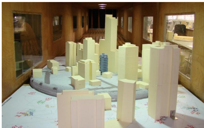
Figura 29 – Edifício D situado interior do túnel de vento
