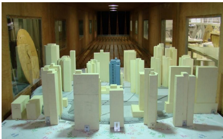
Figura 25 – Edifício C situado no túnel de vento
