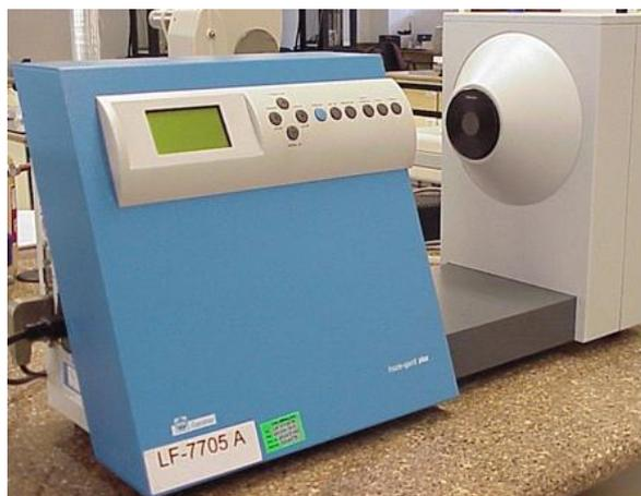
Figura 52 – Fotografia do equipamento Haze-Garde Plus da BYK-Gardner
