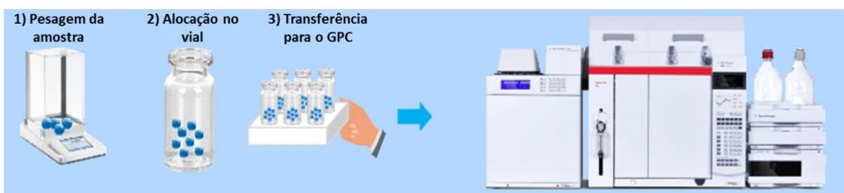
Figura 35 – Ilustração das etapas de preparação e execução da análise de GPC-IR5
