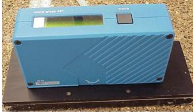
Figura 51 – Fotografia do equipamento Micro Gloss 45° da Byk Gardner
