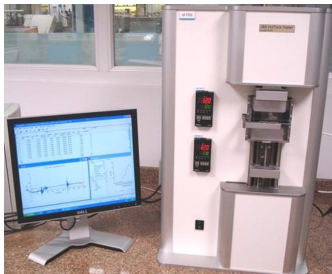
Figura 42 – Fotografia do equipamento usado para determinação das propriedades de selagem
