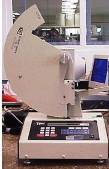
Figura 47 – Fotografia do equipamento utilizado na determinação de resistência ao rasgo Elmendorf
