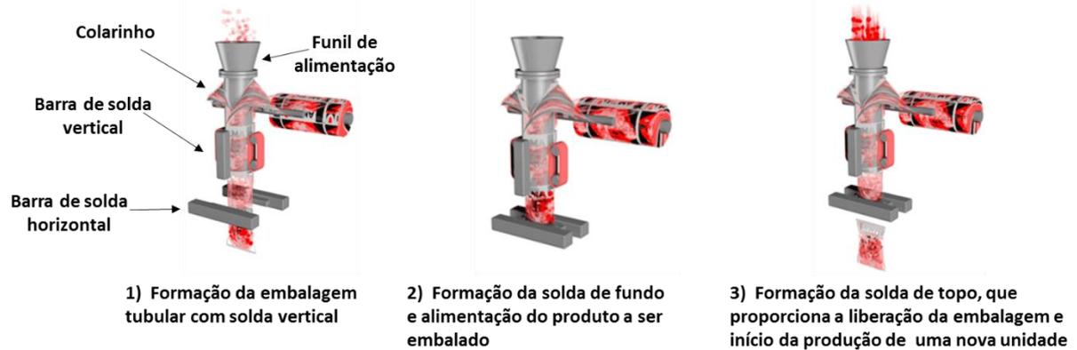
Figura 24 – Ilustração das etapas do processo de empacotamento automático vertical de produtos (VFFS)
