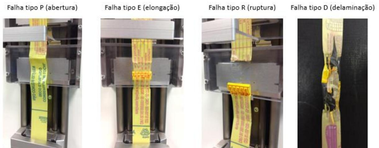
Figura 43 – Fotografia dos tipos de falha na análise de Hot Tack
