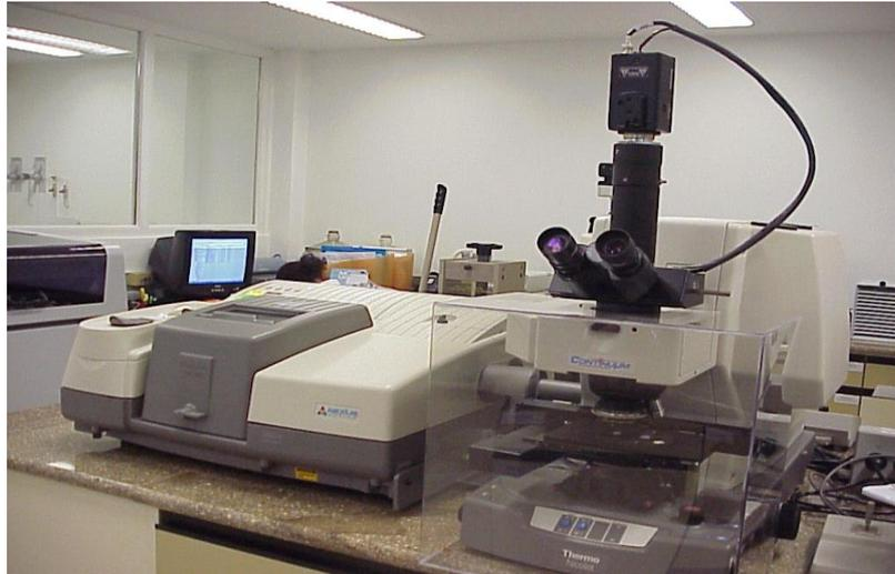
Figura 32 – Fotografia do equipamento utilizado para análise de FTIR
