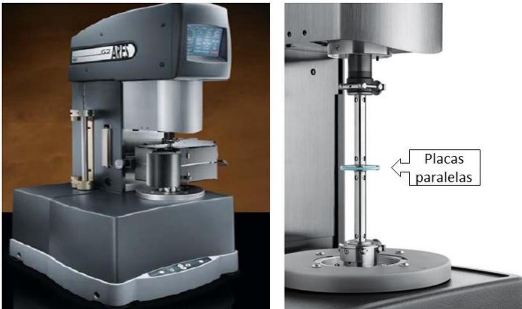
Figura 39 – Imagens de um reômetro rotacional ARES G2
