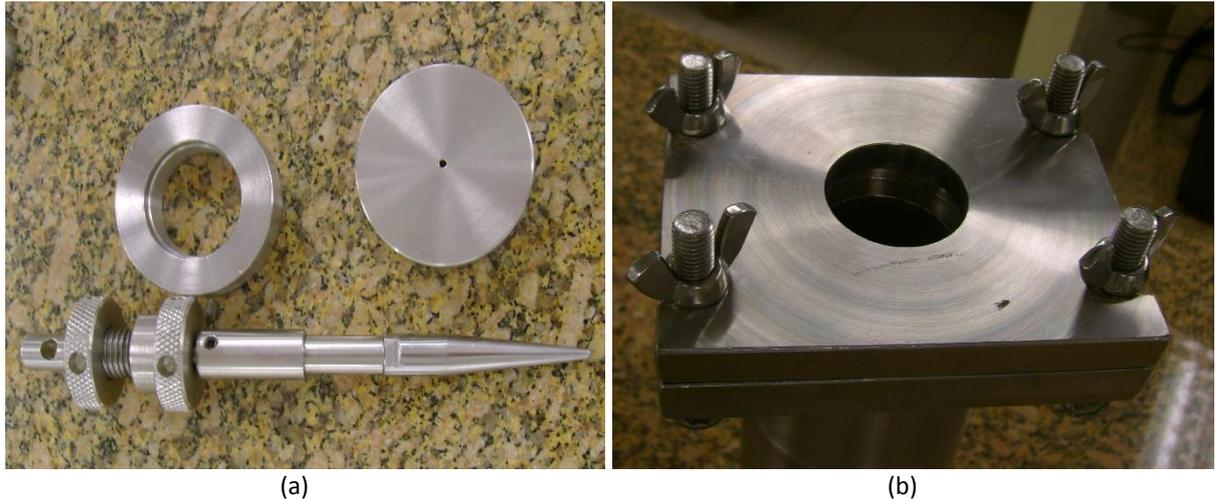
Figura 49 – Fotografias da (a) ponteira e (b) dispositivo de fixação do filme para o ensaio de perfuração
