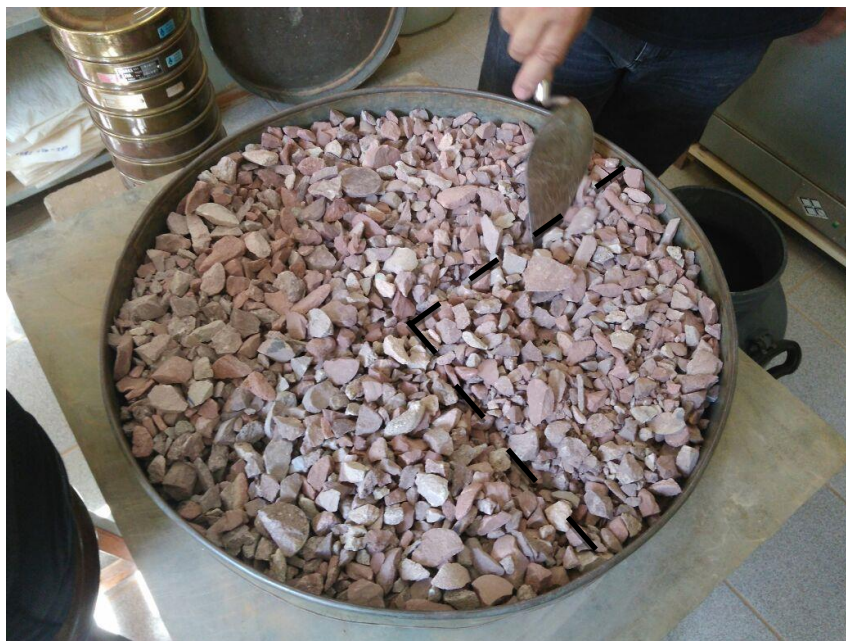
Figura 17 – “Quarteamento” da Amostra
