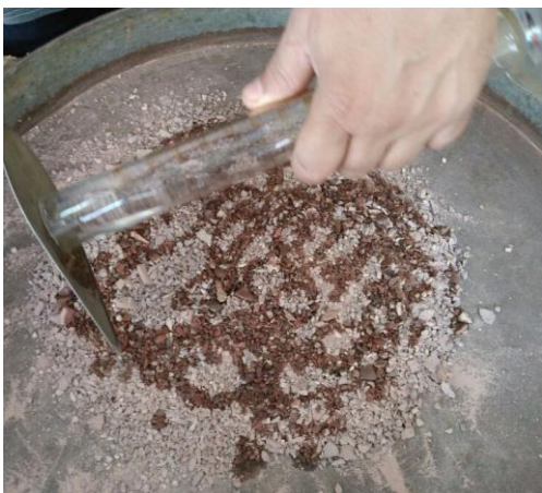
Figura 22 – Aplicação de 3% de Umidade
