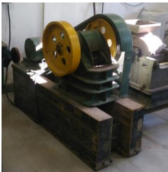
Figura 15 – Britador de Mandíbula
