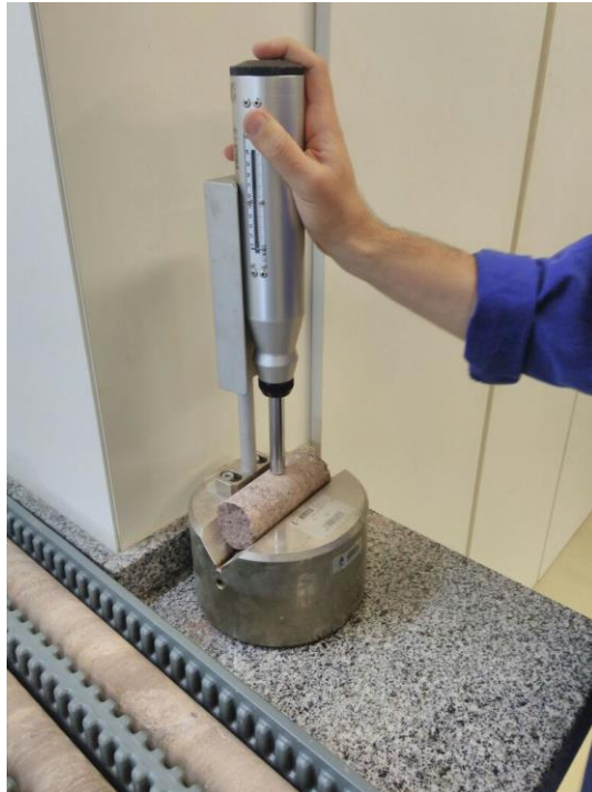
Figura 13 – Esclerômetro Schmidt: índices UCS e JCS
