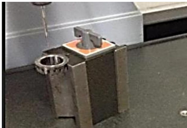
Figura 21: Engrenagem sendo medida no equipamento de medição tridimensional, marca TESA e modelo Micro-hite 3D.
