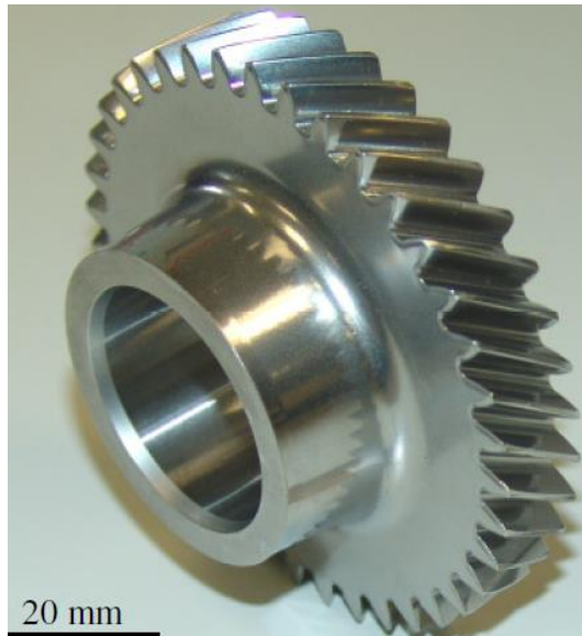
Figura 11: Engrenagem helicoidal sinterizada com a superfície densificada pelo processo a frio – SSD [19].
