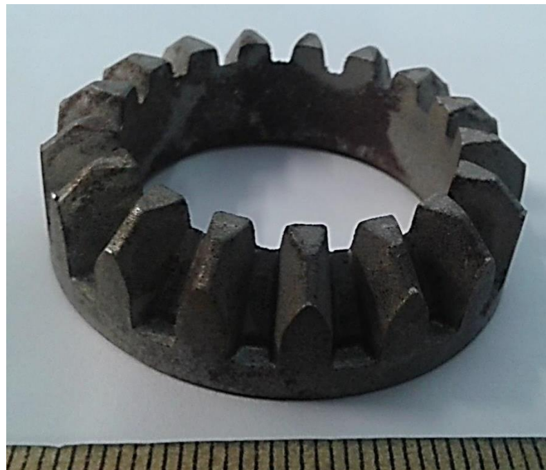
Figura 1: Engrenagem cônica desenvolvida neste trabalho.
