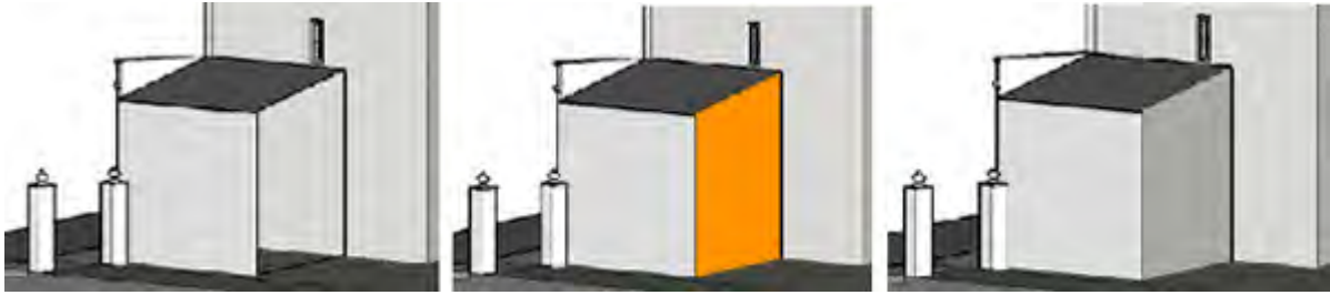
Figura 59: Esquerda: lacuna; centro: figura que melhor preenche a lacuna; direita: diferenciação de textura para evitar falsificação
