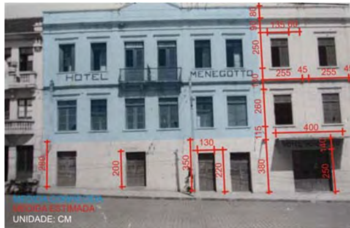
Figura 56: Aquisição de medidas por inferência simples Fonte: Guareze (2006).
