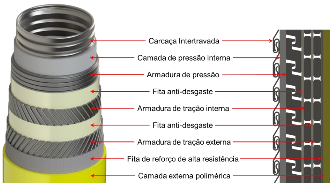
Figura 4: Camadas do duto flexível unbonded
