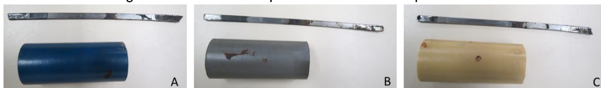
Figura 66: Amostras de pullout envelhecidas após o ensaio
