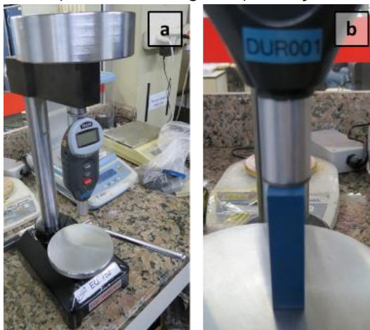
Figura 35: a) durômetro digital b) medição de dureza
