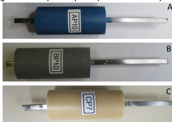
Figura 36: Corpos de prova para ensaios de pullout
