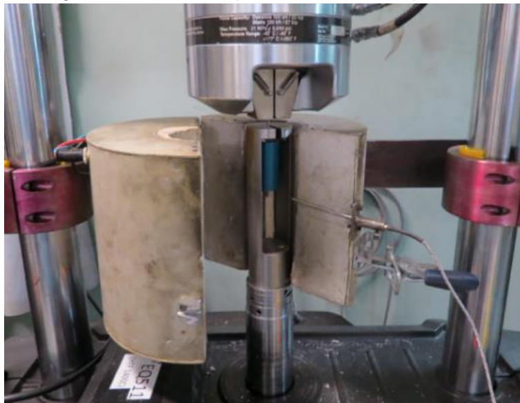
Figura 40: Ensaio de pullout sob alta temperatura
