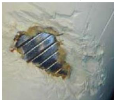
Figura 17: Falha da camada polimérica externa
