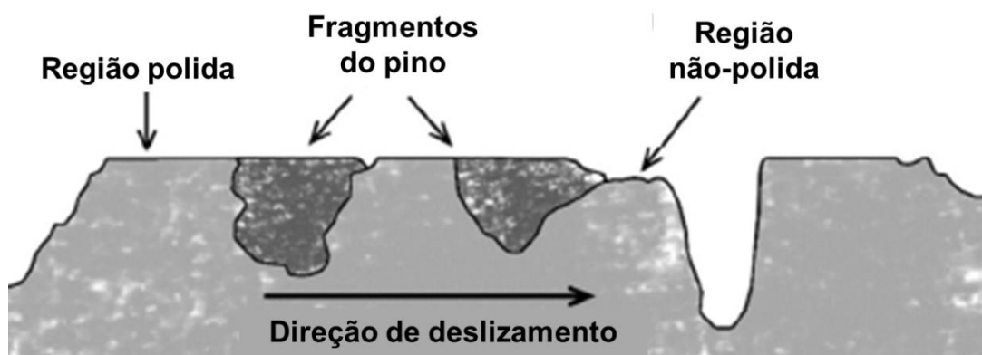
Figura 28 - Esquematização do fenômeno de agarramento dos fragmentos do pino nas superfícies revestidas de menor rugosidade superficial e aumento das interações adesivas
