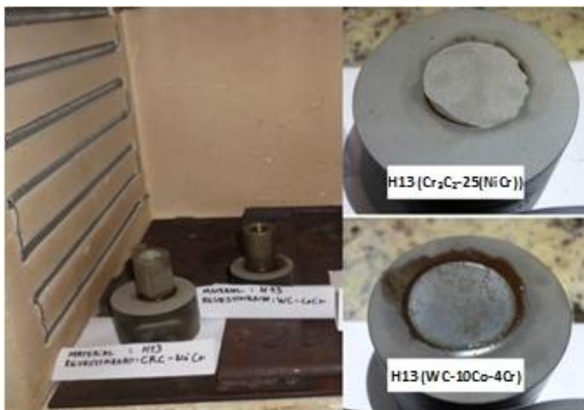
Figura 56 -Punções de aço ABNT H13 revestidos após os ensaios de adesão
