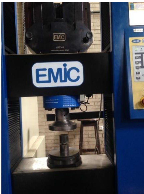
Figura 42 - Prensa EMIC utilizada na compressão dos anéis
