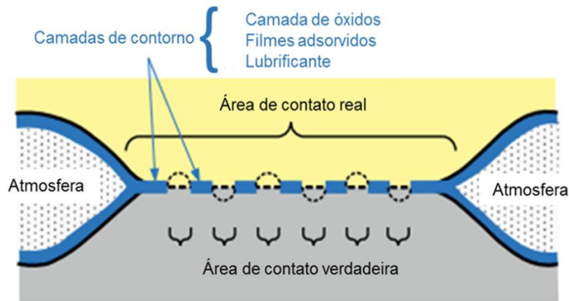
Figura 6 -Modelo que propõe a influência de óxidos, filmes adsorvidos e lubrificação de contorno influenciando na área de contato entre dois corpos
