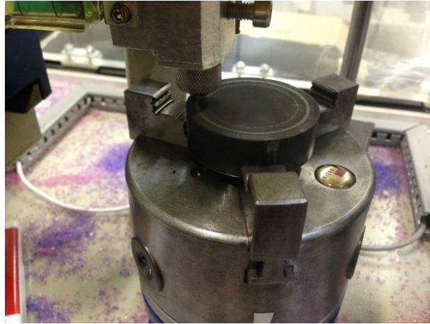
Figura 40 - Equipamento tribômetro utilizado para o ensaio pino-disco em operação
