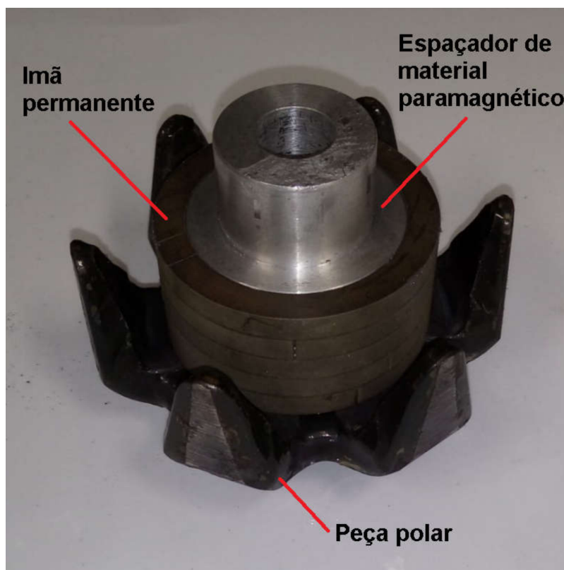
Figura 13 – Montagem do Imã Permanente no Rotor.
