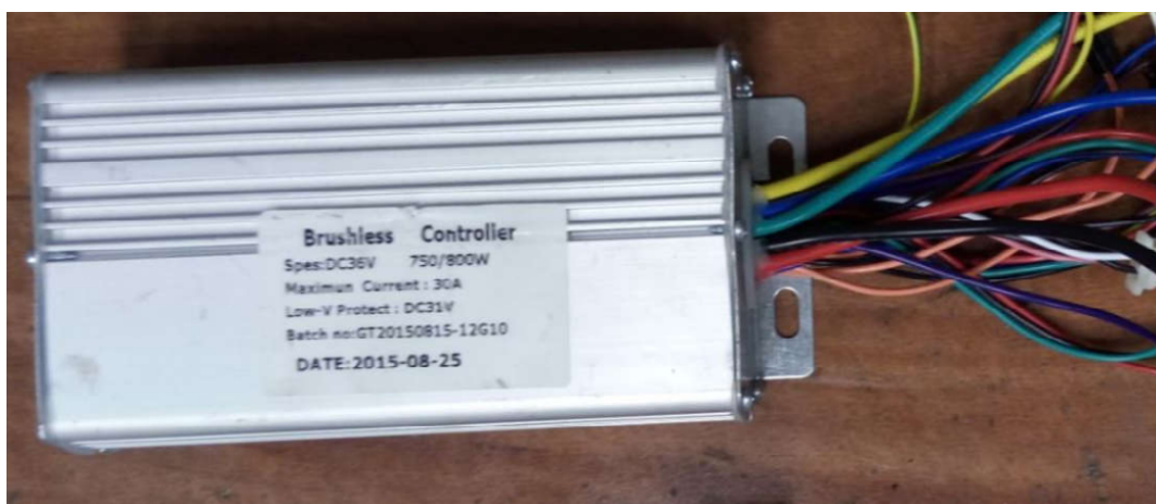
Figura 20 – Controlador Brushless GT20150815 - 12G10 800W 30A.
