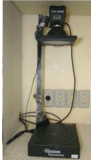
Figura 9: Foto do equipamento de medida de PCD através do método de QSSPCD utilizado neste trabalho.
