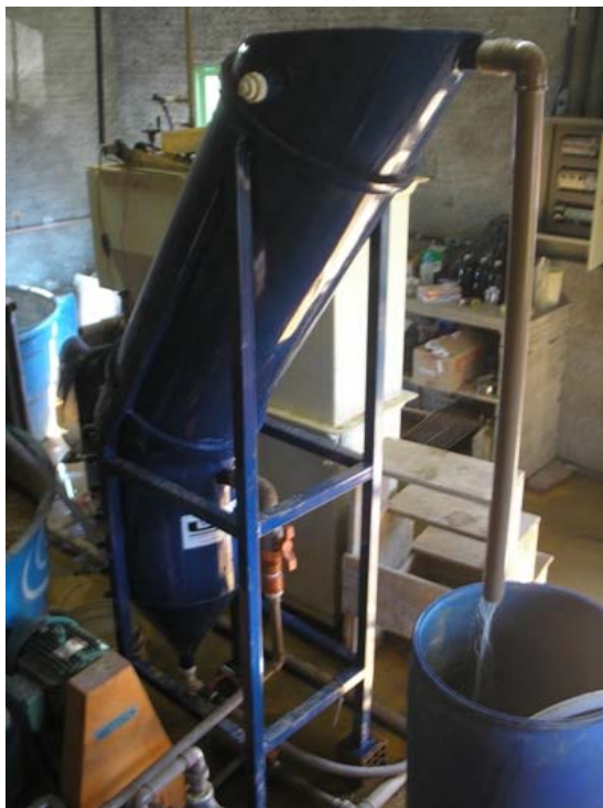
Figura 29. Tanque de sedimentação lamelar (SL) usado nos estudos piloto de tratamento da DAM-COMIN
