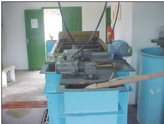
Figura 4. Estação DAM da carbonífera Metropolitana ( 5-10 \text{ m}^3 \cdot \text{h}^{-1} ). Processo NF-FAD ou Flotação por Ar Dissolvido
