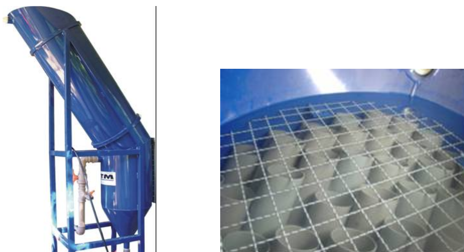
Figura 31. (A) Vista lateral do tanque de sedimentação usado nos estudos piloto de tratamento de DAM; (B) Detalhe dos tubos inclinados inseridos dentro do tanque de sedimentação
