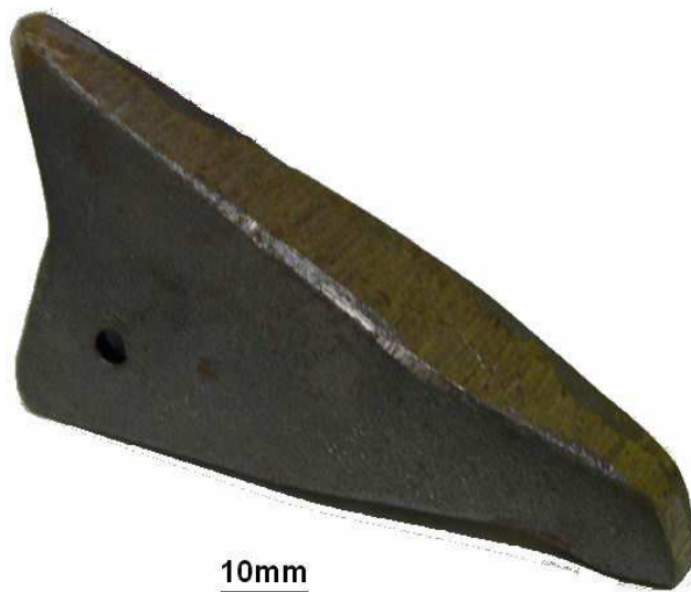
Figura 11 - Corpo-de-prova usado no ensaio de desgaste
