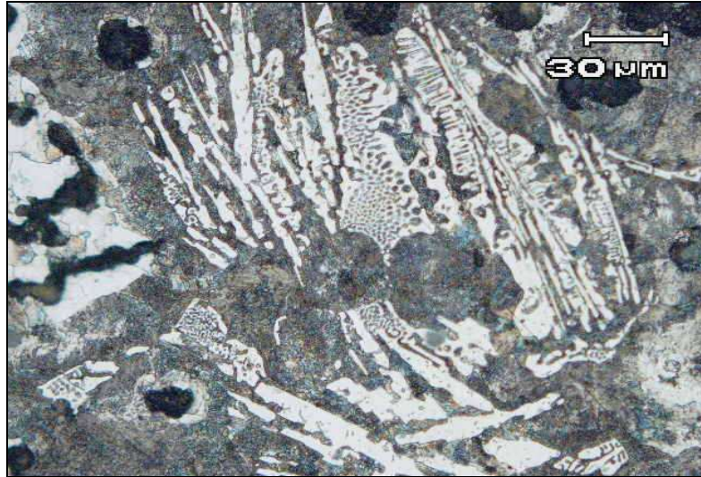
Figura 3 - Microestrutura do ferro fundido nodular. Presença de carbonetos de coquilhamento inverso - Ataque – Picral (ISRAEL, 2004).
