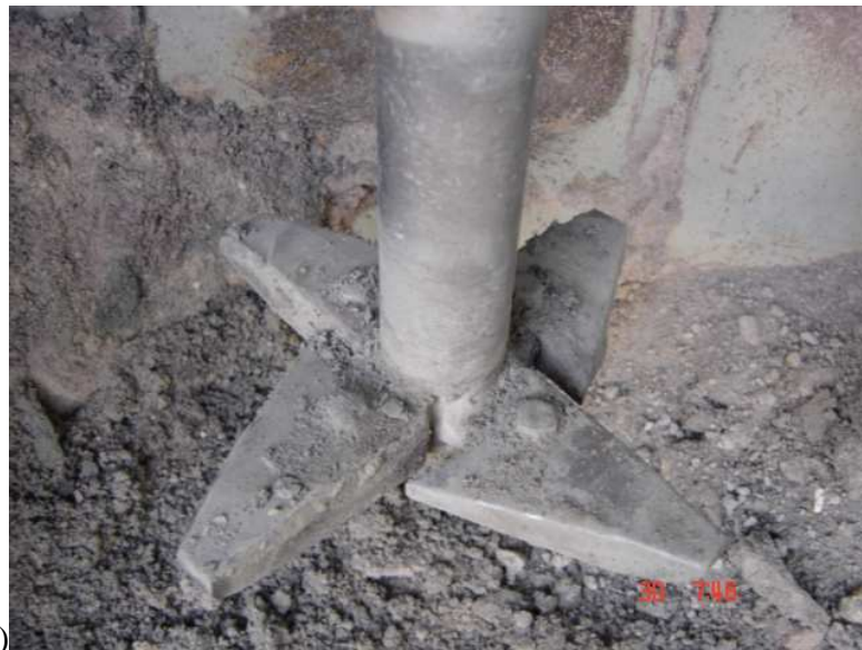
Figura 12 – Máquina de ensaio de desgaste. a) Aspecto geral do equipamento; b) Disposição das peças no eixo de ensaio.
