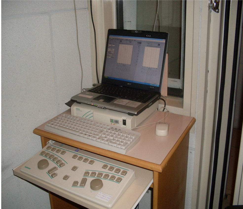
Figura 7. Equipamento Unity PC utilizado na realização de audiometria de frequências ultra-altas de 250 a 16.000 Hz. O fone encontra-se dentro da cabine.
