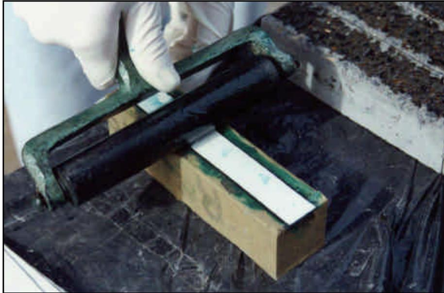
FIGURA 5.8 - Retirada do ar aprisionado e excesso de adesivo
