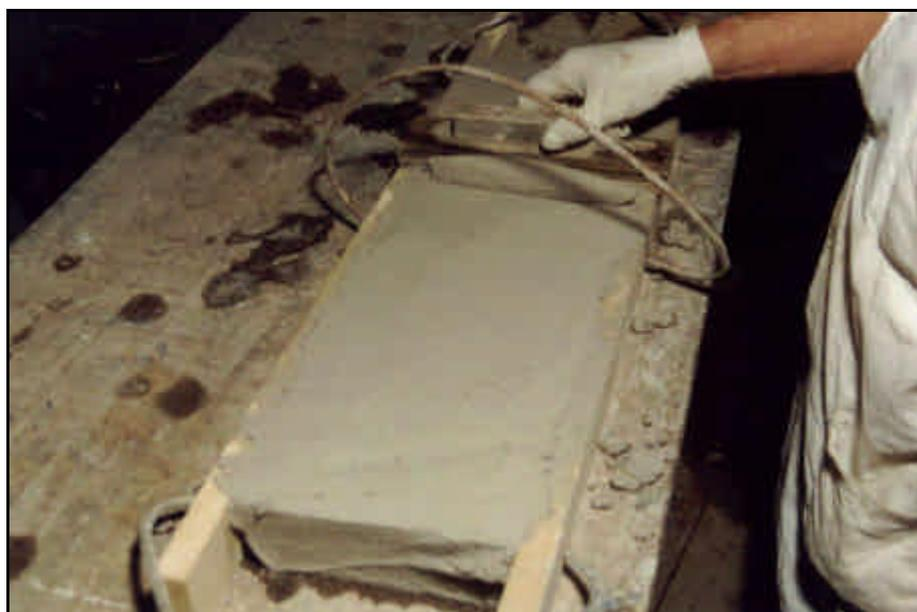
FIGURA 5.14 – Desempeno da argamassa de revestimento
