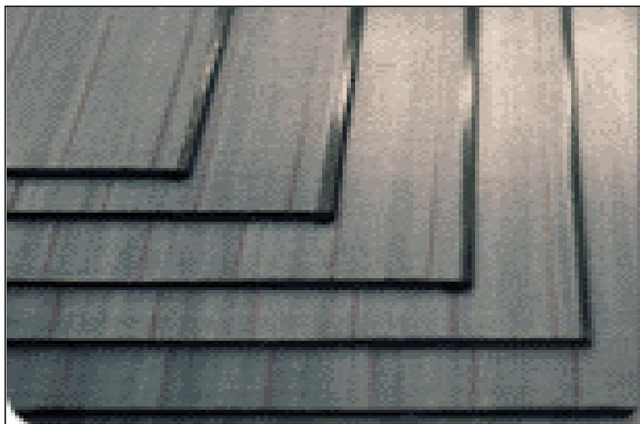
FIGURA 2.1 – Sistema de reforço com chapas pultrudadas
