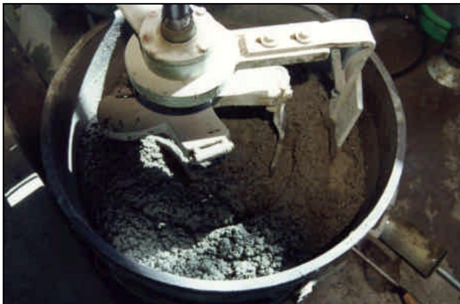
FIGURA 5.1 – Mistura dos materiais constituintes do concreto
