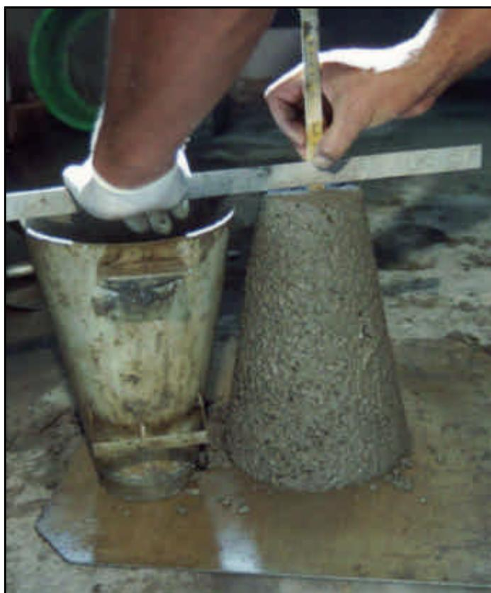
FIGURA 5.2 – Determinação da consistência do concreto
