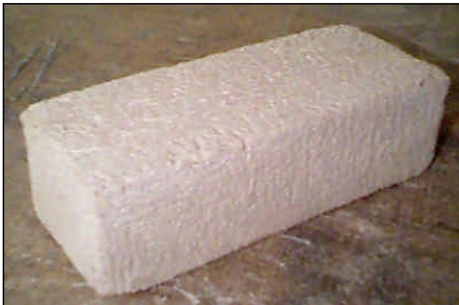
FIGURA 5.15 – Modelo protegido com argamassa de revestimento
