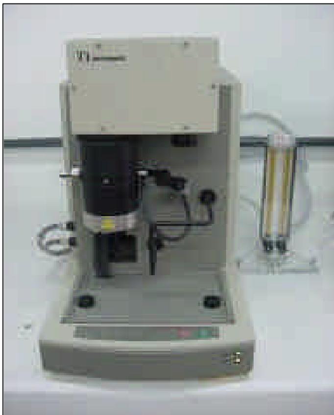
FIGURA 5.25 – Equipamento utilizado na análise termogravimétrica
