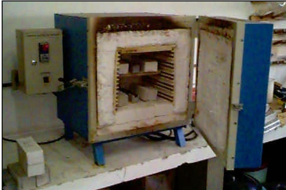
FIGURA 5.21 – Forno utilizado para expor modelos a temperaturas elevadas
