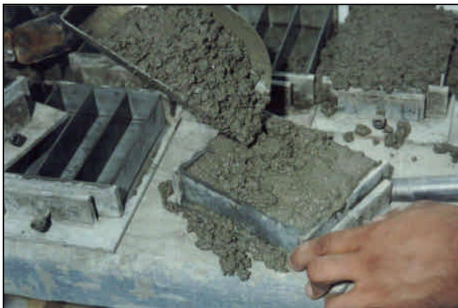
FIGURA 5.3 - Concretagem dos modelos
