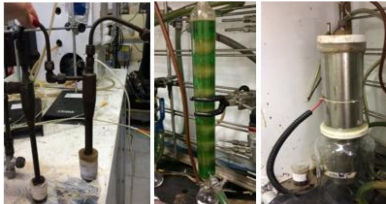
Figura 3. Ciclones, Condensador e Precipitador, da esquerda para a direita.
