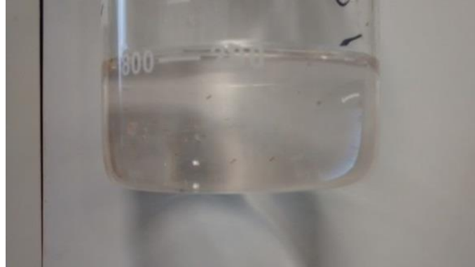
Figura 5.5- Solução de trealose após processo de impregnação a vácuo.
