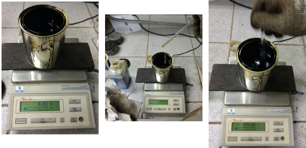
Figura 28: Procedimento de adição do aditivo surfactante.
