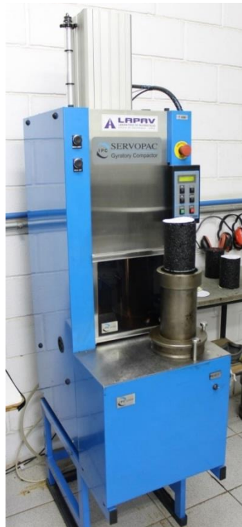
Figura 33: Compactador giratório Superpave
