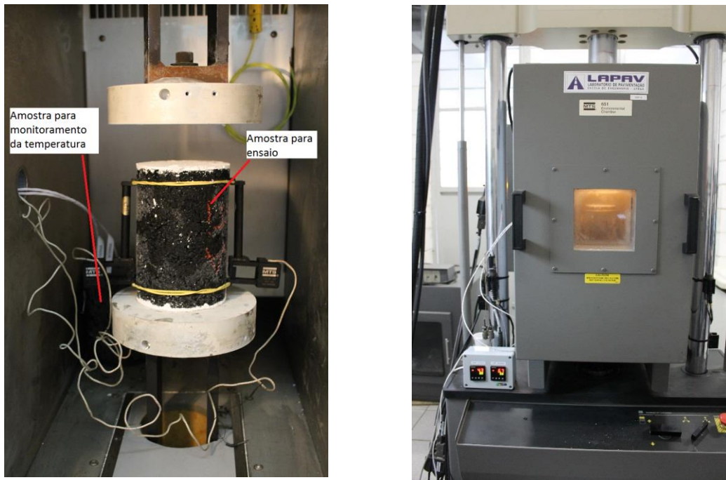
Figura 34: Condicionamento do corpo de prova
