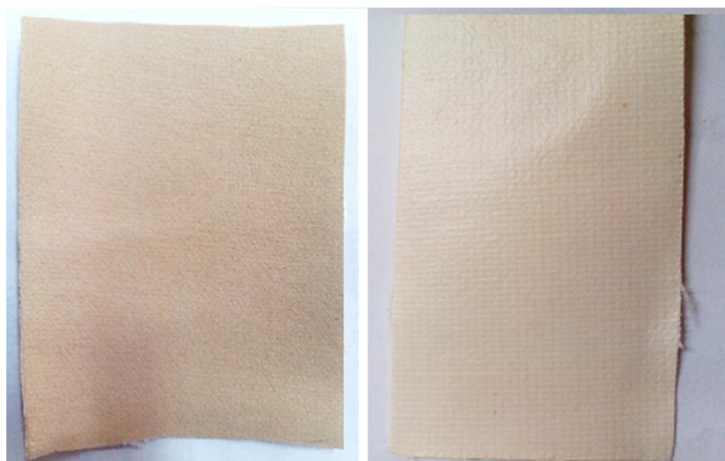
Figura 7 – Fotos das membranas italianas IONAC (a) MC-3470 (Catiônica) e (b) MA-3475 (Aniônica).
