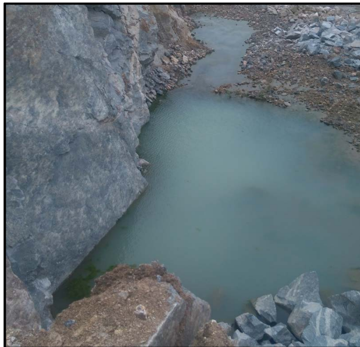
Figura 17 - Acumulo de água em local indevido devido à falta de canais de drenagem.
