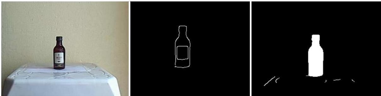
Figura 3.9 - Detección de bordes de las formas propuestas, usando el algoritmo planteado por Canny
