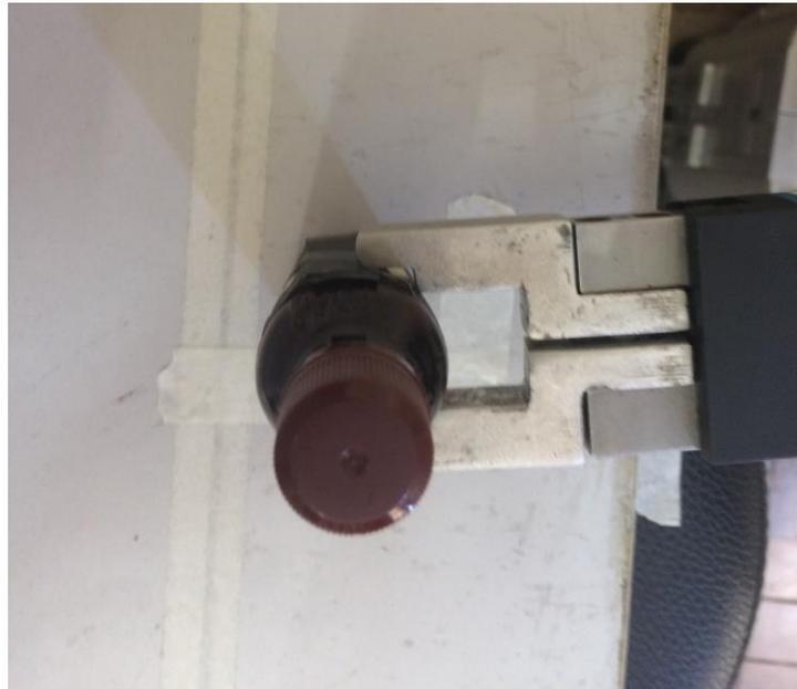
Figura 4.18 - Objeto target capturado por la pinza del robot RP5GDL
