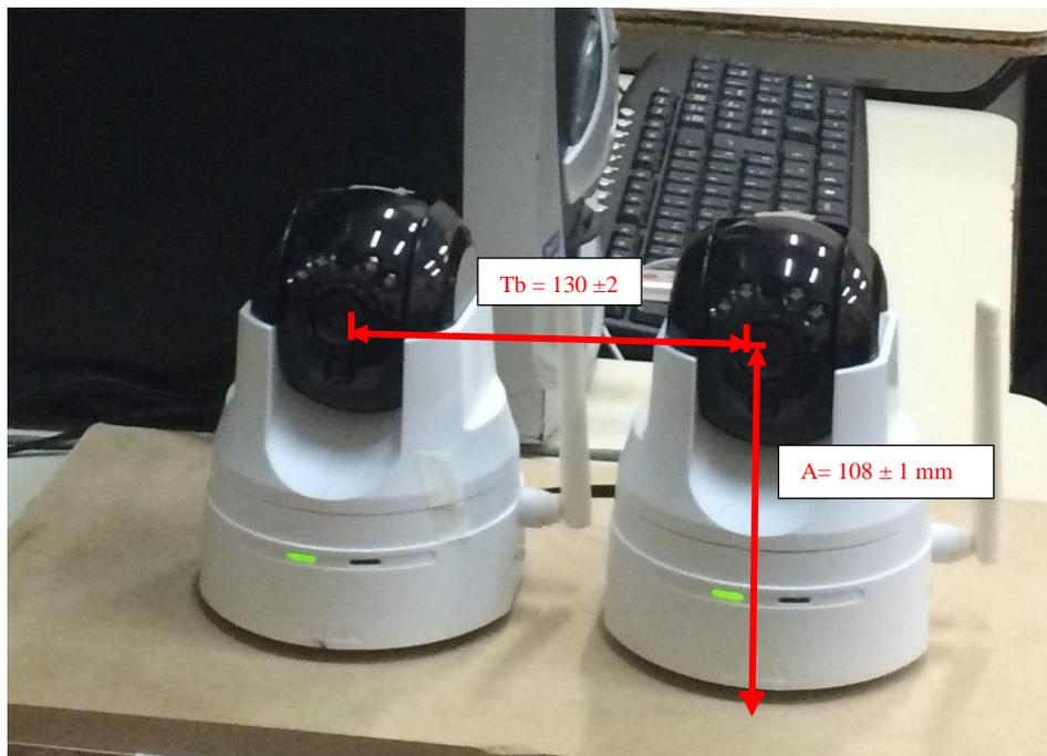
Figura 3.6 - Arreglo de cámaras en el sistema estereoscópico y compensación para alineación en el eje y
