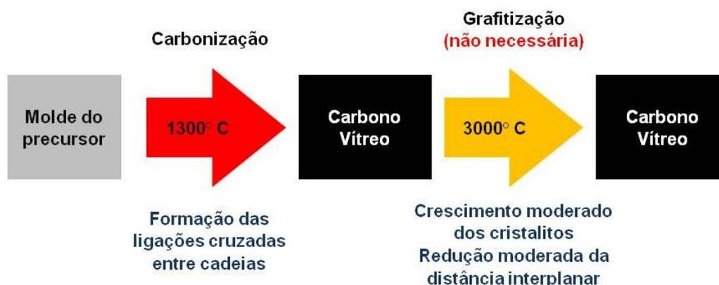
**Figura 6** – Esquema da síntese de carbono vítreo.
