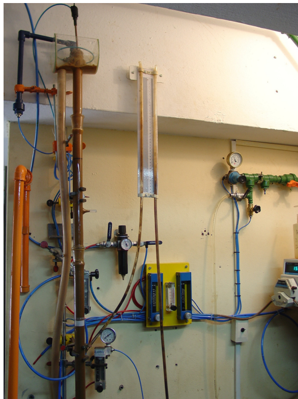
Figura 14. Coluna de flotação utilizada nos estudos de flotação em laboratório.
