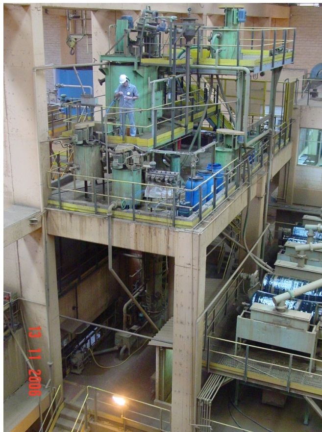
Figura 27. Vista parcial da unidade piloto de flotação em coluna de 24'' da Usina de Concentração de minério de fosfato da Bunge-Araxá.
