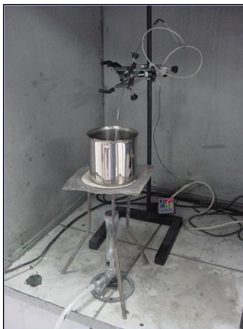
Figura 6.2 - Aparato utilizado na síntese por combustão em solução.
