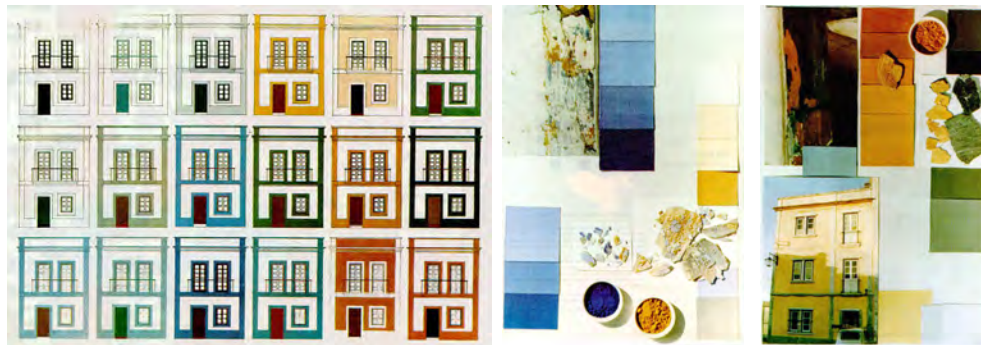
Figura 3.22: Exemplo de estudos de cor para recuperação do centro histórico de Beja, em Portugal. Fonte: Aguiar (2005: 336).
