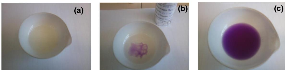
Figura 2.4: Esquema de cores do ensaio de presença de AT. (a) antes da adição de KOH alcoólico; (b) durante a adição de KOH alcoólico; (c) após adição de KOH alcoólico.
