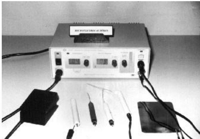
Figura 1. Microcautério e ponteiros para corte, aspiração ou descolamento.
