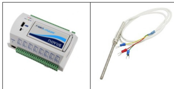
Figura 1: Imagem do módulo de aquisição de dados (esquerda) e de um sensor de temperatura do tipo PT100 (direita)
