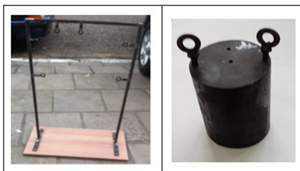
Figura 2: Estrutura metálica utilizada para suspensão do cilindro de aço (esquerda) e imagem ampliada desse cilindro (direita)
