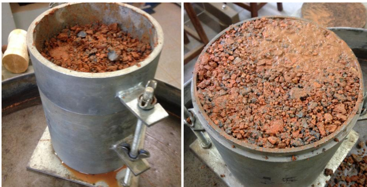
Figura 19 – Exsudação de água na base do molde e no topo do corpo de prova
