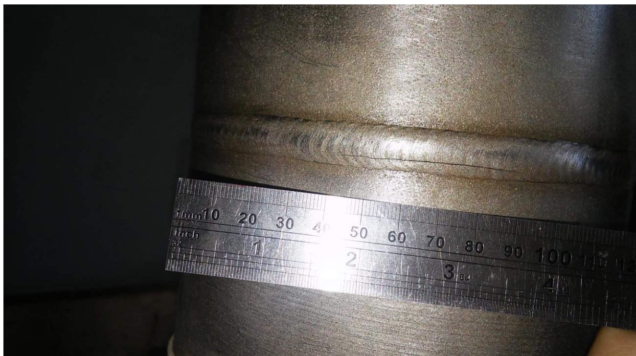
Figura 79. Defeito gerado por fadiga na superfície do cordão de solda no ciclo 863.165.
