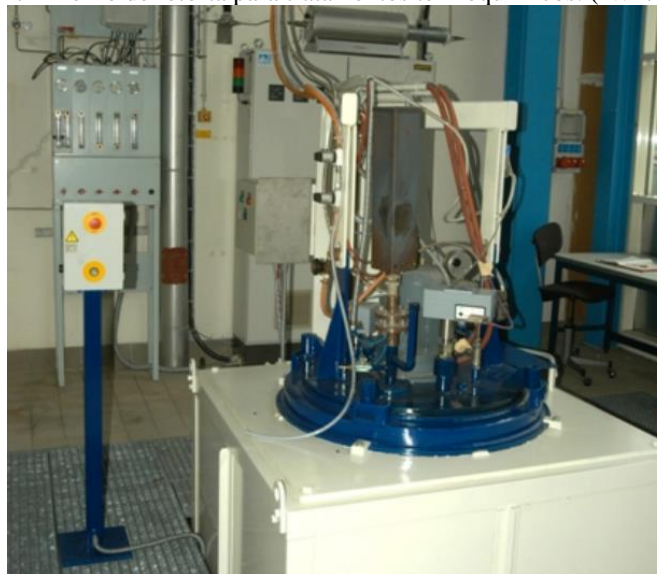
Figura 17 – Forno de retorta para tratamentos termoquímicos. (IWT/Bremen)
