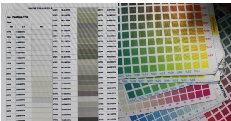
Figura 53 - Pantone TPX e escala Benday impressos em estamparia digital indireta por sublimação
