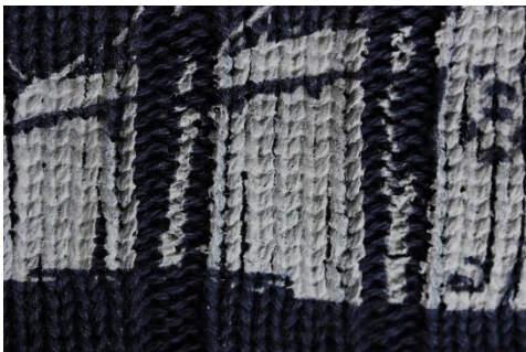
Figura 61 - Desnível em estrutura de malha retilínea
