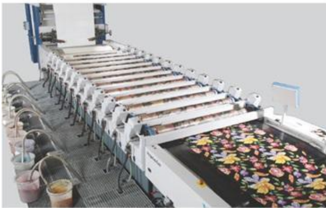
Figura 12 - Tecido impresso em serigrafia por cilindro
