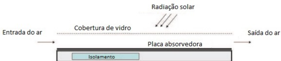
Figura 4.1 - Coletor solar de placa plana. (Adaptado de Languri e Ganji, 2011)
