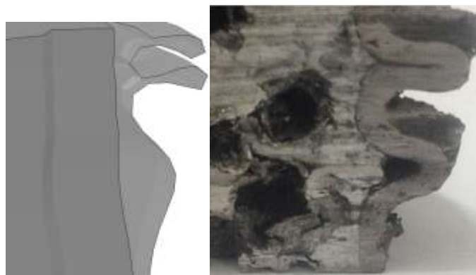
Figura 4.23 Descolamento da interface tubo de aço/ espuma de alumínio e dobramento da face do tubo para o teste de compressão.
