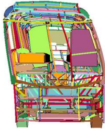
Figura 5.27 Estrutura deformada sem espuma
