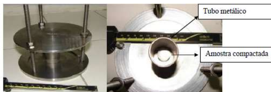
Figura 4.4 Disposição da amostra compactada no interior do tubo.
