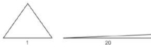
Figura 2.9 Comparação de razão de aspecto para um triângulo. Adaptado manual do usuário ANSYS v.17.
