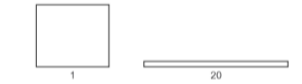
Figura 2.11 Comparação de razão de aspecto para um quadrilátero. Adaptado manual do usuário ANSYS v.17.
