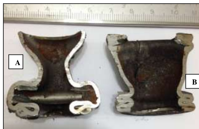
Figura 4.15 Corte transversal ensaio de compressão. (A) sem tratamento térmico, (B) modificado termicamente.
