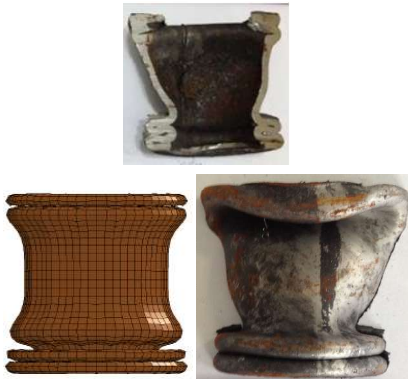
Figura 4.19 Comparativo deformada – Modelo numérico e experimental.
