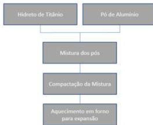
Figura 2.27 Esquemática do processo de fabricação da espuma de alumínio.
