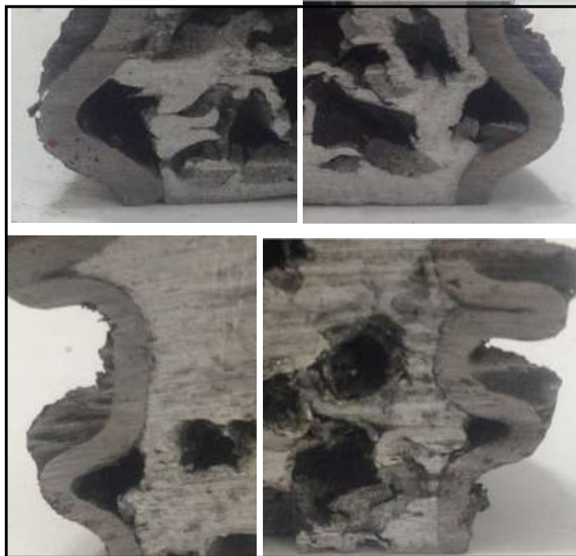
Figura 4.17 Descolamento da interface aço/alumínio.
