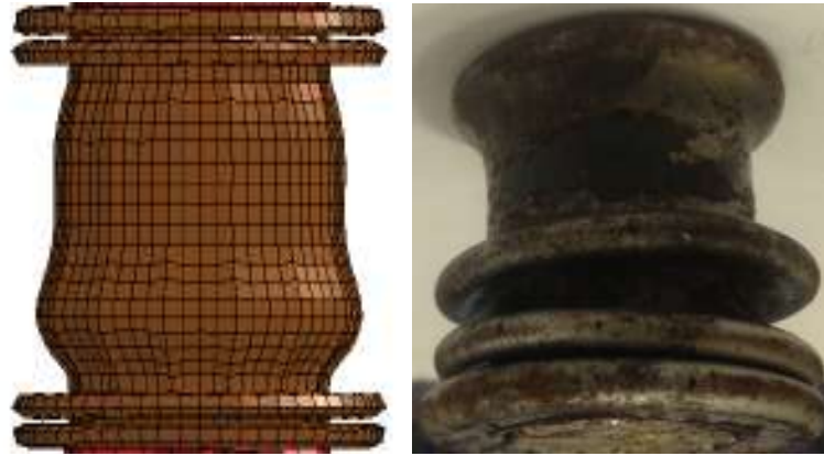
Figura 4.21 Comparativo deformada – Modelo numérico e experimento.
