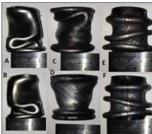
Figura 4.11 Ensaio de compressão. A, B: Tubos sem tratamento térmico, C, D: Tubos modificados termicamente, E, F: Tubos com preenchimento de alumínio.
