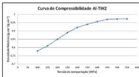
Figura 2.30 Curva de compressibilidade da mistura pó de alumínio e hidreto de titânio.
