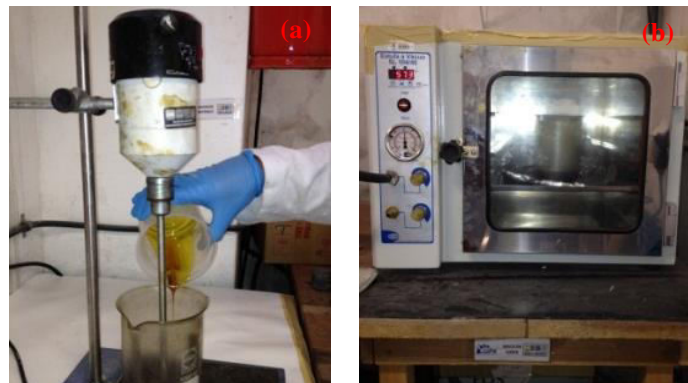
Figura 10 - Mistura da resina com endurecedor no agitador mecânico (a) e degasagem da resina na estufa a vácuo (b) antes da injeção.
