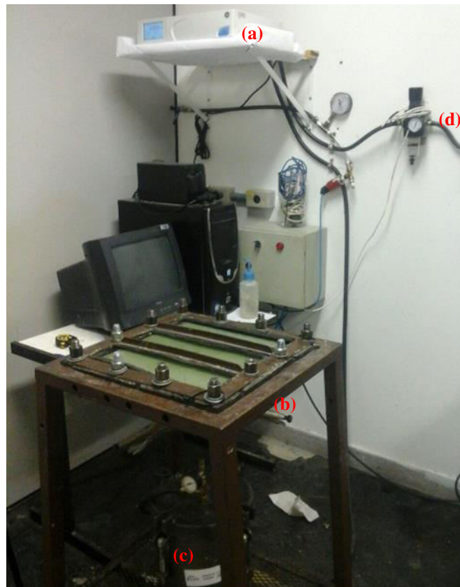
Figura 8- Aparatos do sistema RTM: controlador e regulador de pressão (a), molde (b), vaso de pressão (c) e filtro regulador de pressão de ar (d).
