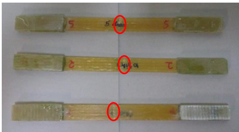
Figura 49 - Falha em tração (ASTM D3039) das amostras que sofreram carregamento mecânico.
