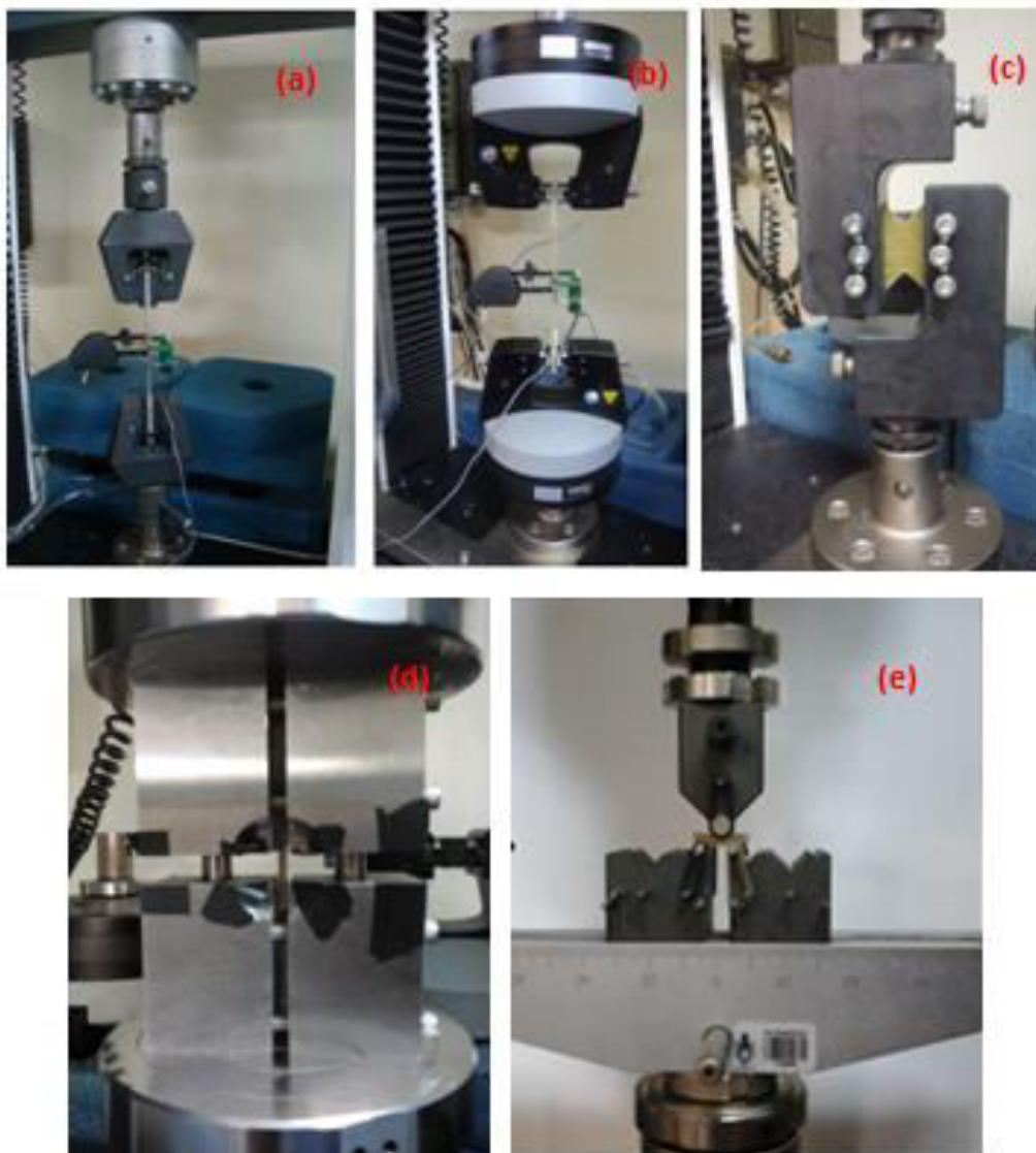
Figura 13 - Ensaio de tração com garra mecânica (a) e garra pneumática (b), ensaio de cisalhamento no plano (c), ensaio de compressão (d) e ensaio de resistência short-beam (e).
