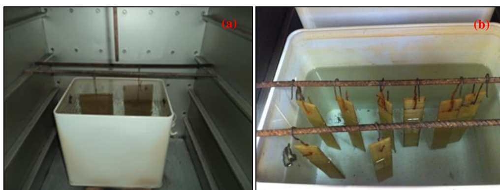
Figura 17 - Imagens das placas para ensaio de DMA e short-beam (a), e tração (b) no ambiente de envelhecimento acelerado.
