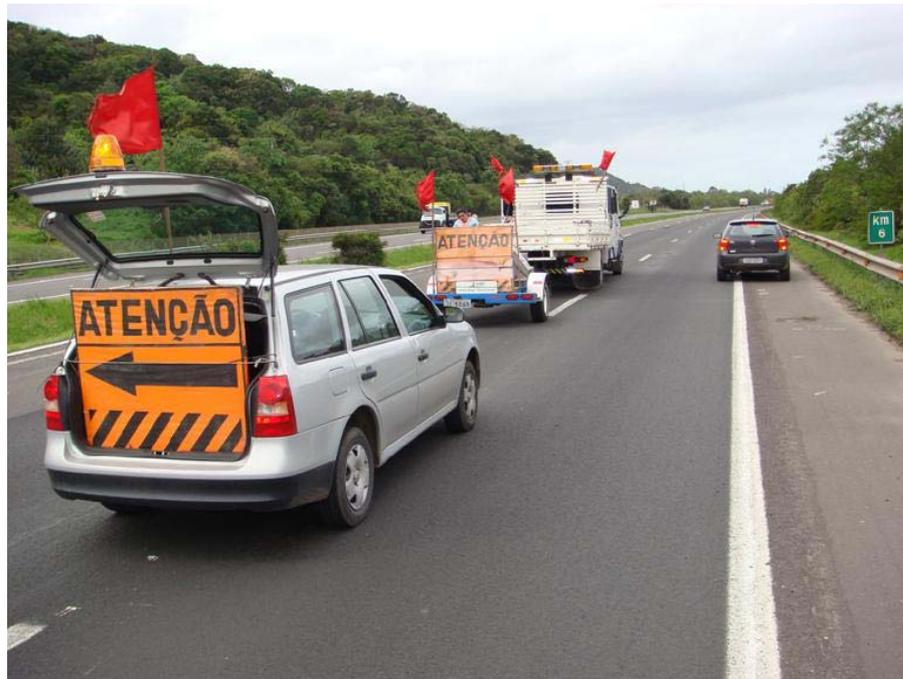
Figura 15: Comboio de veículos empregados no levantamento de deflexões com FWD (reboque no veículo da frente).
