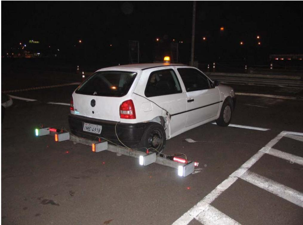
Figura 17: Perfilômetro a laser em levantamento ocorrido na rodovia BR-290/RS.
