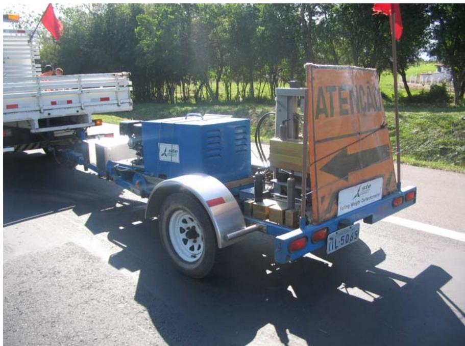
Figura 16: Detalhe do levantamento realizado na rodovia BR-290/RS com o equipamento FWD.
