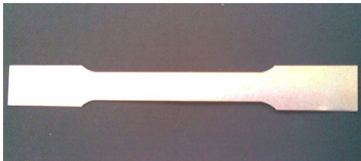
Figura 43: Corpo de prova usinado.
