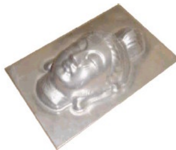
Figura 20: Painel decorativo, produzido através da técnica ISF [34].
