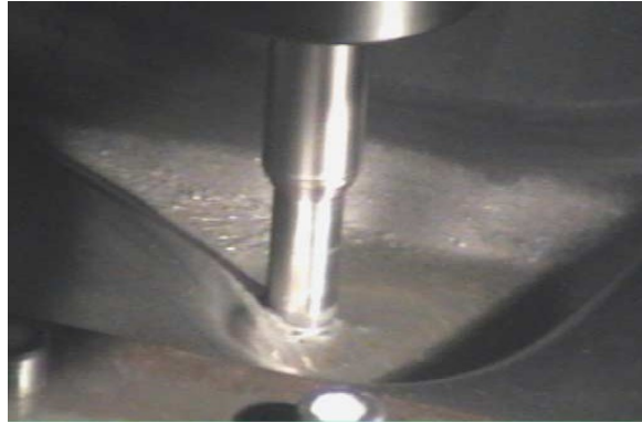
Figura 13: Ferramenta no processo de estampagem [24].
