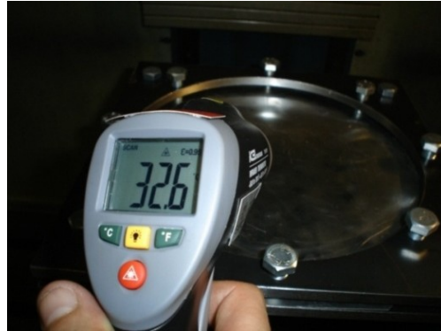
Figura 38: Coleta da temperatura durante o processo de estampagem incremental.
