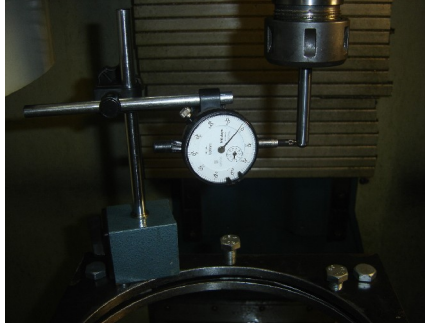
Figura 40: Medição da excentricidade da ferramenta.
