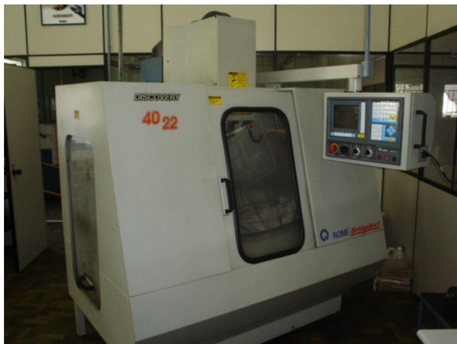
Figura 28: Centro de usinagem discovery modelo 4022, romi com comando MACH9.
