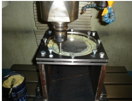
Figura 39: Aplicação de lubrificante no processo de estampagem incremental.
