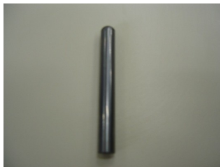
Figura 30: Ferramenta de estampagem incremental.
