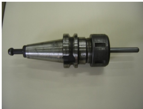
Figura 31: Ferramenta presa no mandril.
