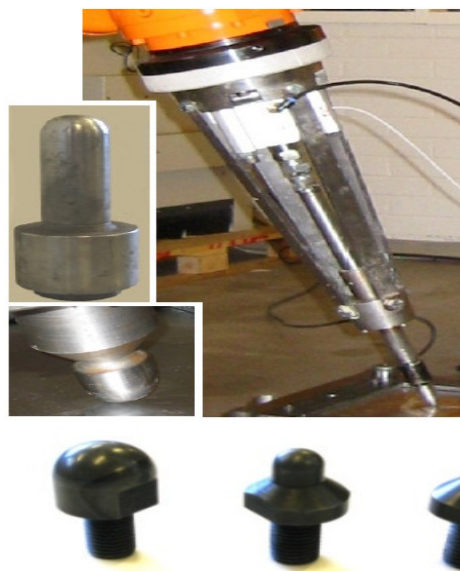
Figura 4: Ferramentas de estampagem utilizadas na robótica [13].
