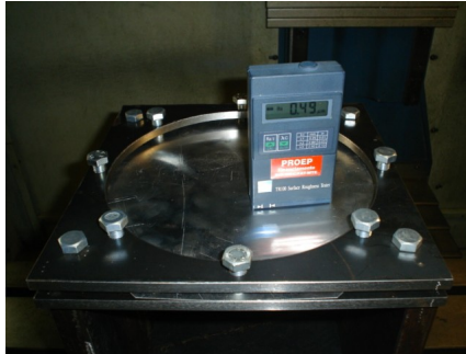
Figura 41: Medição da rugosidade da chapa a ser estampada.
