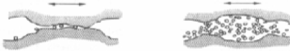
Figura 8. Representação esquemática de desgaste corrosivo [35].
