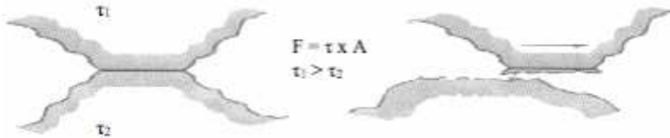
Figura 5. Representação esquemática do desgaste adesivo [35].
