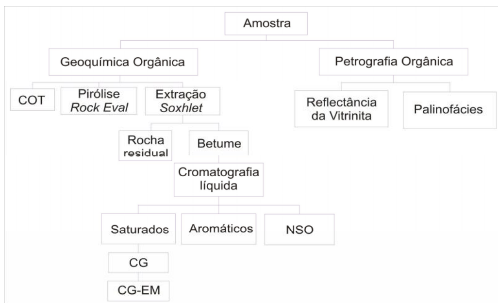
Figura 5: Fluxograma dos métodos analíticos. (COT=Carbono Orgânico Total; CG=Cromatografia Gasosa; CG-EM=Cromatografia Gasosa acoplada à Espectrometria de Massa; NSO=Heterocomponentes).
