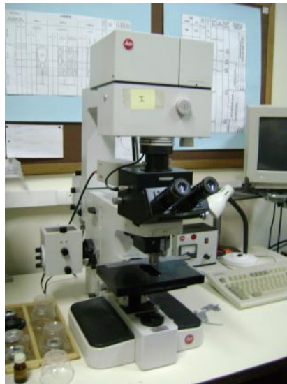
Figura 11: Microscópio de luz refletida utilizado nas análises da Reflectância da Vitrinita.
