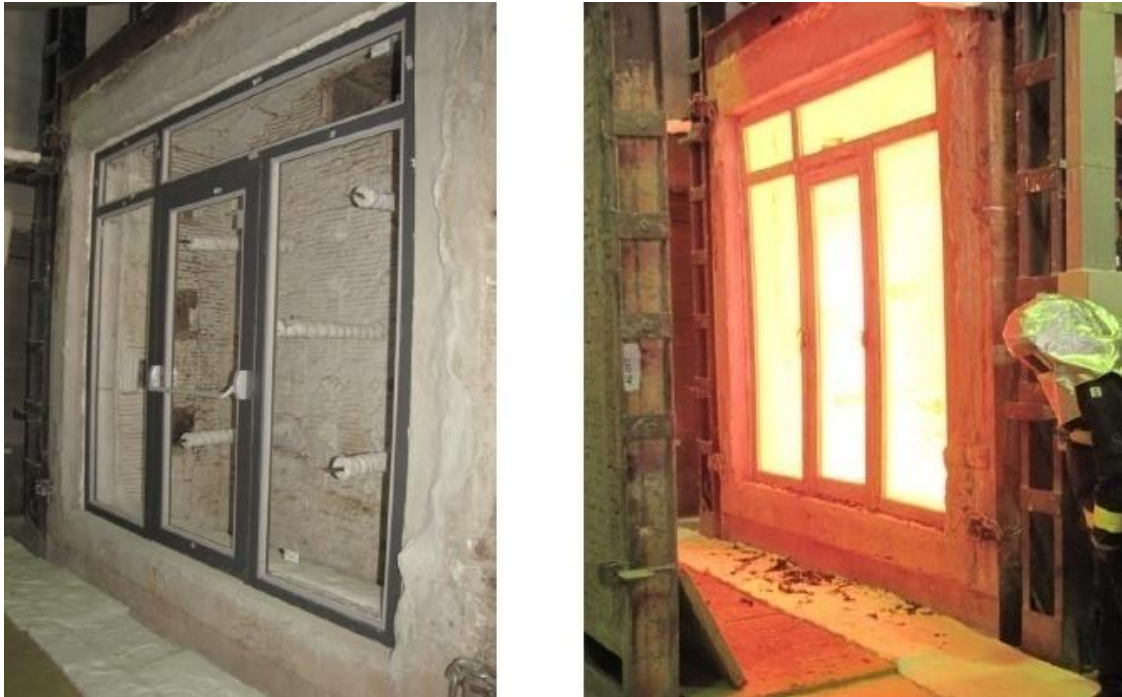
Figura 43 – Ensaio de resistência ao fogo em unidade envidraçada
