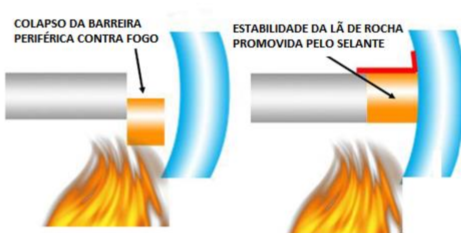
Figura 19 – Selante proporciona estabilidade à barreira periférica contra fogo
