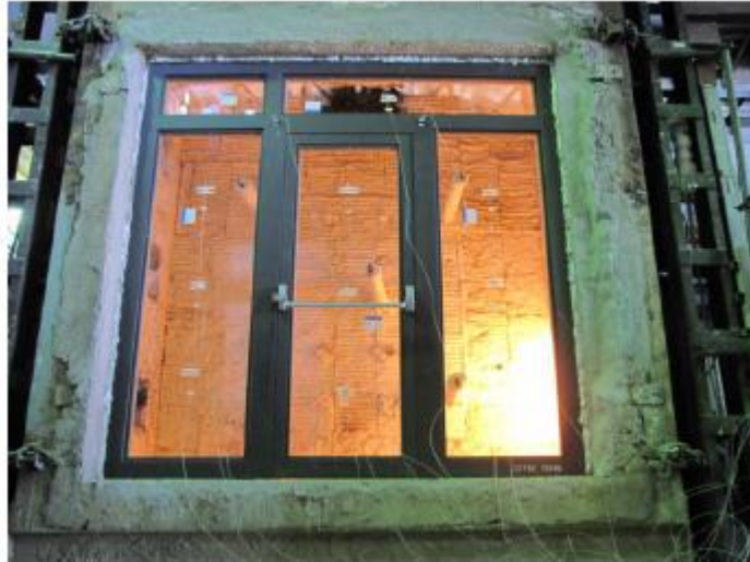
Figura 23 – Parede de vidro corta-fogo
