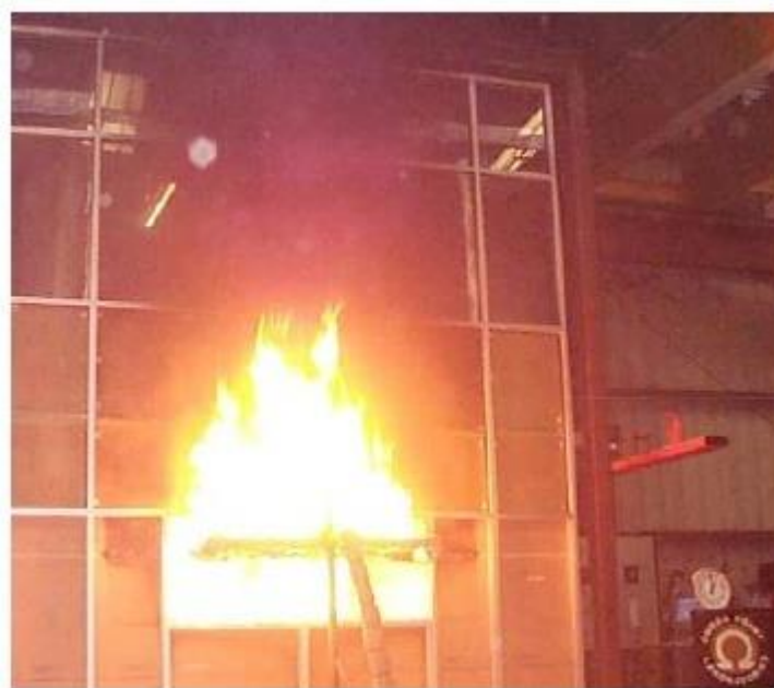
Figura 37 – Característica do incêndio gerado pelo queimador externo em uma fachada de teste com o montante de alumínio centralizado
