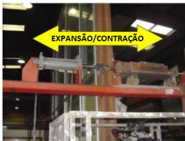
Figura 35 – Ensaio de movimento cíclico
