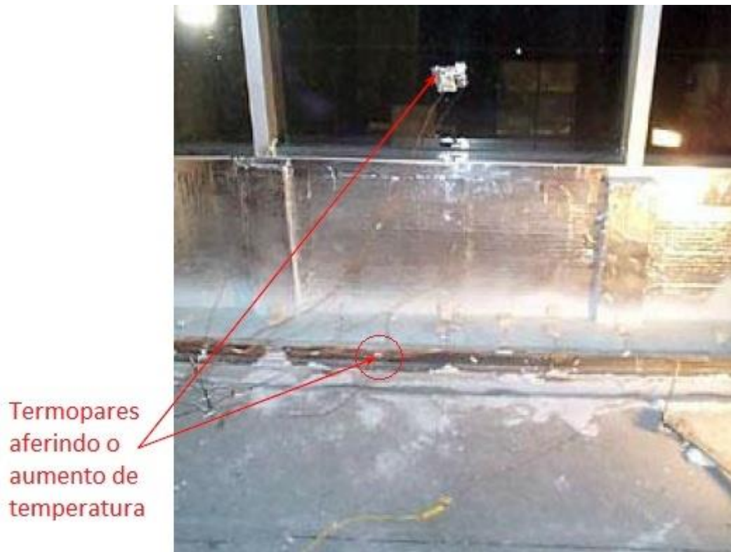
Figura 41 – Localização de alguns termopares antes do início do ensaio
