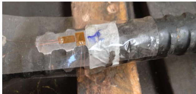
Figura 31. Colagem dos gauges com auxílio de fita gabarito.
