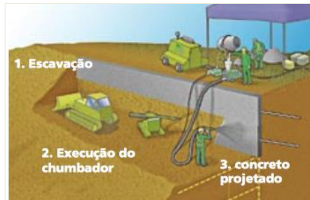
Figura 5. Etapas construtivas de solo grampeado
