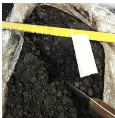
Figura 49. Amostra de itabirito silicoso friável retirada do talude.
