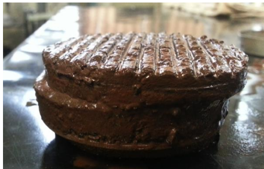
Figura 55. Corpo de prova rompido para ensaio inundado.
