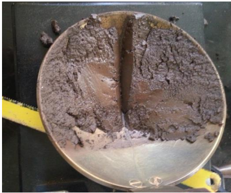
Figura 51 – Ensaio LL, primeira tentativa com sucesso de moldagem.
