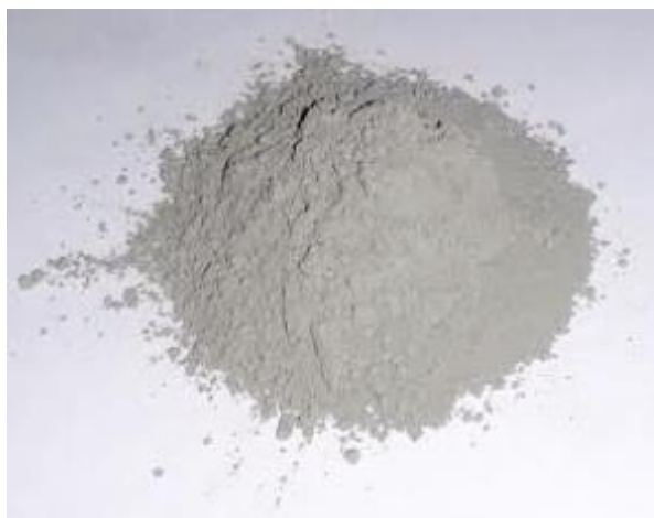
Figura 17: Aspecto do cimento Portland com fíler calcário.
