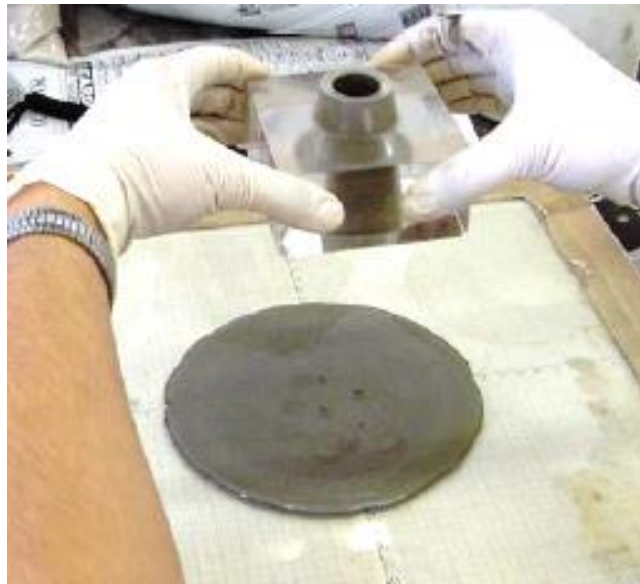
Figura 26: Demonstração do ensaio de mini abatimento.
