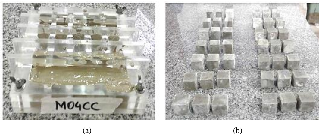
Figura 24: (a) Corpos de prova moldados para ensaio de resistência à compressão. Na imagem, moldagem dos traços PNS04CP I e PNS04CPIIF (parte superior da imagem) (b) Corpos de prova prontos para ensaio de compressão axial, após serem regularizados e medidos.
