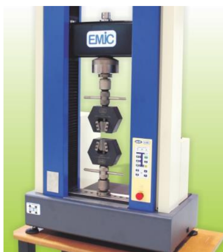
Figura 23: Modelo da prensa utilizada nos ensaios de resistência à compressão.
