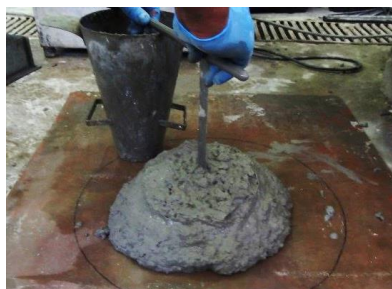
Figura 20 – Execução do ensaio de abatimento pelo tronco de cone e aspecto visual do concreto fresco
