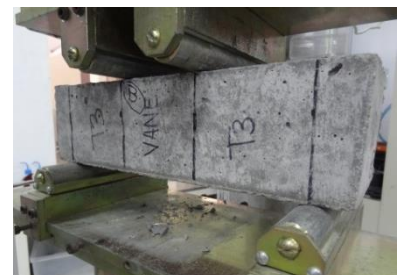
Figura 16 – Dispositivo de quatro pontos e demarcação dos terços médios (a) representação esquemática; (b) registro do ensaio de abertura de fissuras
