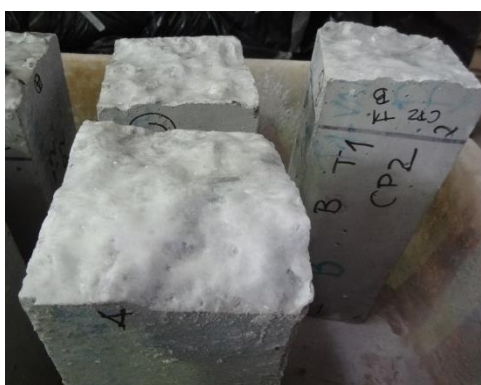
Figura 24 – Aspecto visual dos corpos de prova com aplicação de parafina sólida no topo e base
