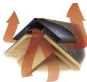
Figura 21 – Ventilação na cumeeira
