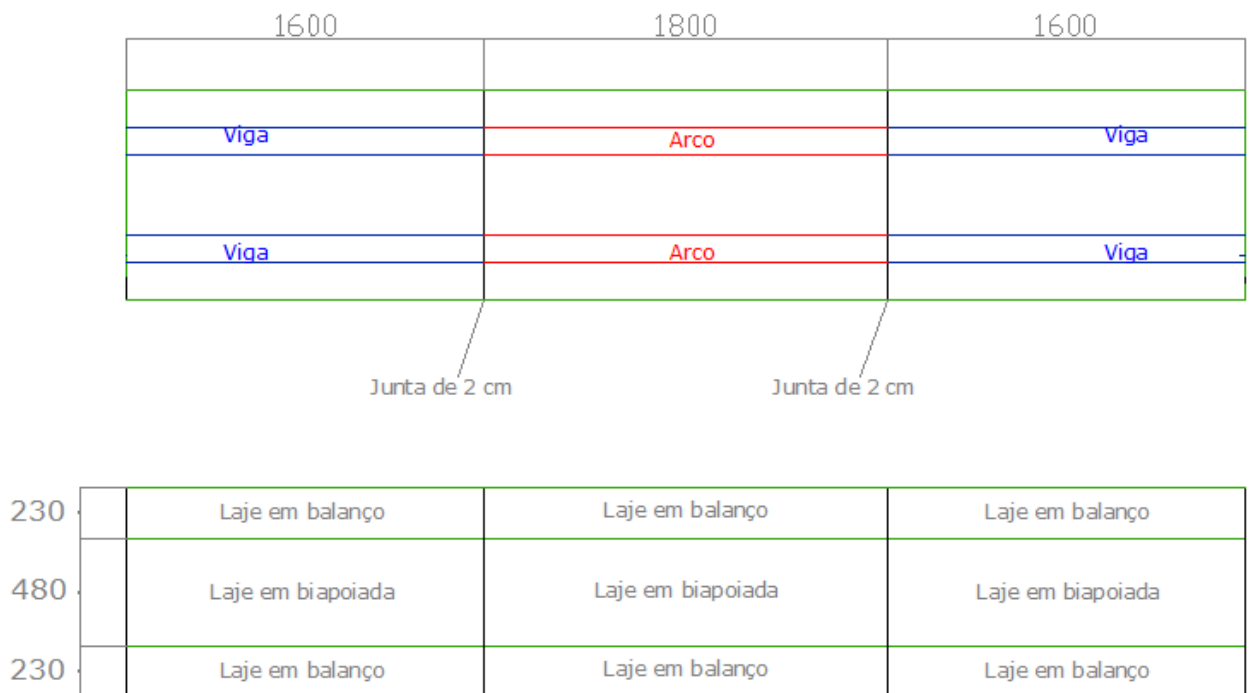
Figura 21 – Representação da divisão das lajes
